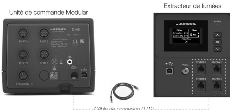
Connecter jusqu'à 4 unités de commande (connecteur FAE/ROBOT) aux connecteurs de l'extracteur de fumées (STATION 1, STATION 2, ...). Chaque outil connecté à ces unités de commande peut démarrer et arrêter l'extracteur de fumées.
